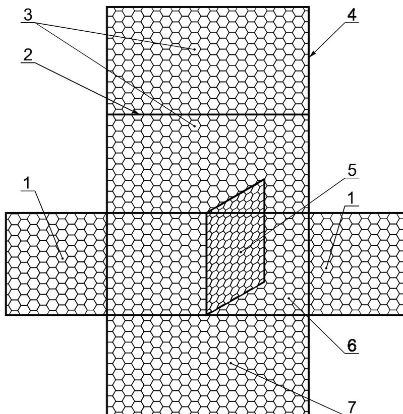
1 — торцевая стенка; 2 — линия сгиба; 3 — крышка и задняя стенка; 4 — проволока кромки; 5 — диафрагма; 6 — дно;
